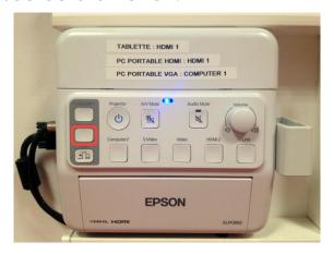
Si un écran bleu apparaît sur la toile de projection, appuyez sur le **bouton HDMI 1** pour afficher l'écran de la tablette tactile.
