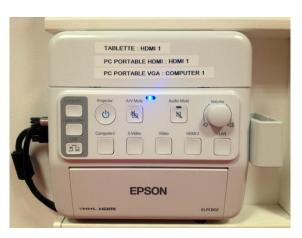
L'interrupteur latéral doit être positionné sur « I » et une LED **bleue** doit être allumée sur le boitier, si c'est le cas <u>passez à l'étape 6</u>
