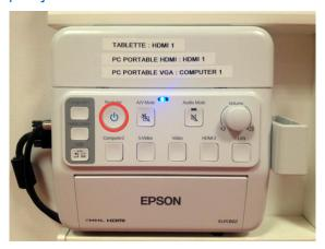
En appuyant sur le **bouton ci-dessus**, Un « **bip** » sonore doit être entendu depuis le vidéoprojecteur situé au plafond et une LED **bleue** devrait s'allumer sur celui-ci, si c'est le cas <u>passez à l'étape 7</u> sinon patientez quelques secondes et appuyez à nouveau sur le **bouton de mise en marche**.
